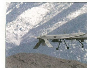
⑤ ⑤アメリカの無人爆撃機 誘導ミサイルや爆弾を搭載し、アメリカ本土の基地から衛星経由で遠隔操作が可能。イラク戦争などに投入されている。
