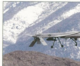
⑤ ⑤アメリカの無人爆撃機 誘導ミサイルや爆弾を搭載し、アメリカ本土の基地から衛星経由で遠隔操作が可能。イラク戦争などに投入されている。
