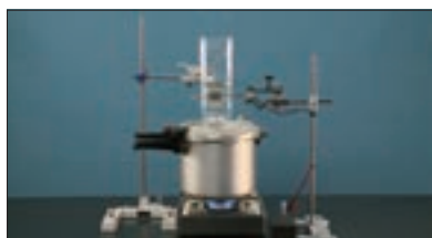
発電装置をつくってみよう・火力発電 学習した知識をいかして作成できる 装置なども紹介しています。
