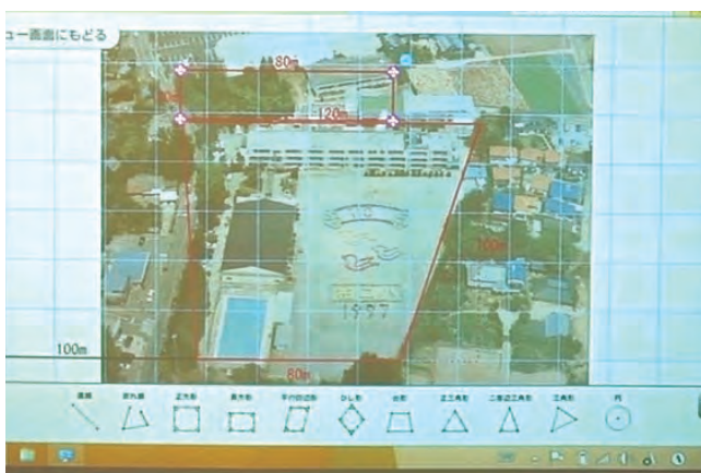
ペン機能で写真上の学校敷地の概形を囲むと、基準としたプールの長さから求積に必要な数値が画面に示される
